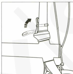
Установите рулевую трубу в вертикальное положение. Убедитесь, в плотном соединении рулевой трубы с нижней частью велосипеда. Поднимите фиксатор вверх, чтобы зафиксировать положение рулевой трубы.
